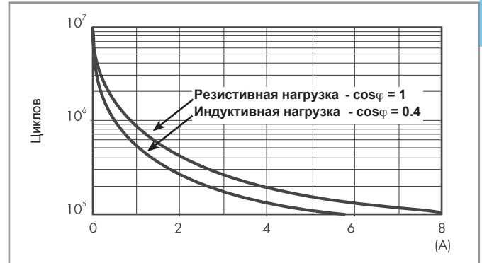
F 40 - Электрическая долговечность (AC) при ном. нагрузке Типы 40.52
