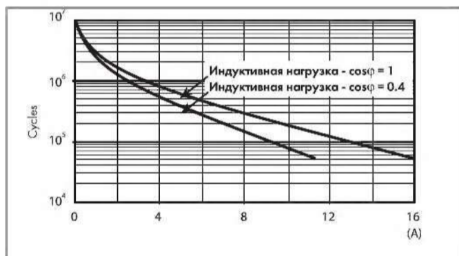
F 40 - Электрическая долговечность (АС) при номинальной нагрузке Типы 40.11/41
