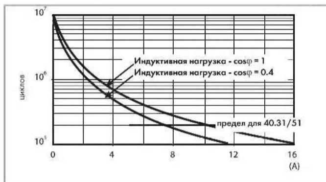
F 40 - Электрическая долговечность (АС) при ном. нагрузке Типы 40.31/51/61
