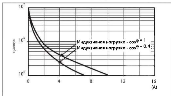
F 36 - Электрическая долговечность (АС) при ном. нагрузке
