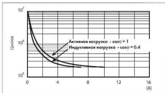
F 60 - Электрическая долговечность (AC) при ном. нагрузке
