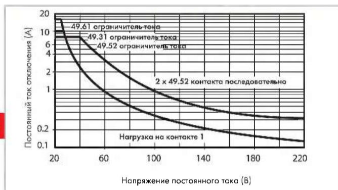
H 49 - Макс. отключающая способность DC1 Типы 49.31/52/61/72/81
