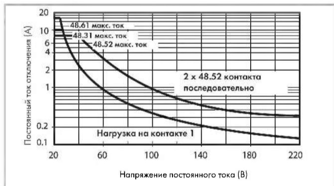
H 48 - Макс. отключающая способность DC1 Типы 48.31/52/61/72/81
