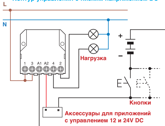
Схема подключения – 1-полюсное реле Контур управления с низким напряжением DC
