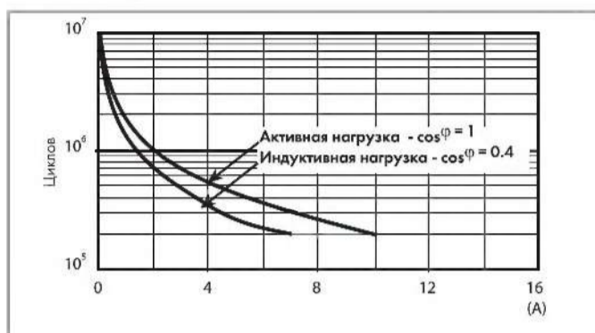
H 59 - Макс. отключающая способность DC1
