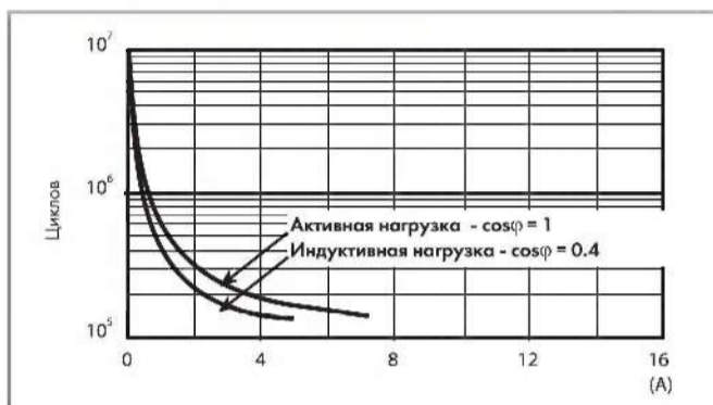
F 58 - Электрическая долговечность (АС) при ном. нагрузке Реле с 4 перекидными контактами
