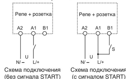
Схема подключения (без сигнала START)      Схема подключения (с сигналом START)
