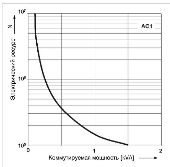
Электрический ресурс по функции мощности нагрузки. Диаг. 1 Частота коммутации: 1 200 циклов/час
